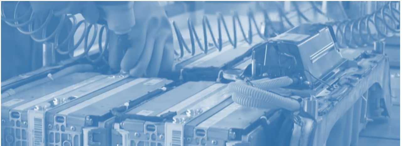
Bildquelle: BR (br.de) In einer Recyclinganlage wird der Batterieblock eines Elektrofahrzeugs geöffnet.
